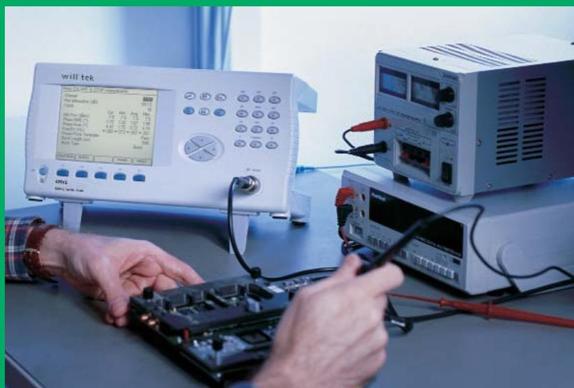
Die automatische Testsequenz liefert einen umfassenden Testbericht, der über das eingebaute Display angezeigt wird oder zu Dokumentationszwecken ausgedruckt werden kann. Zur Beschleunigung der Servicearbeiten kann die Bildschirmanzeige auf Fehlermeldungen beschränkt werden. Ein zusätzlicher Fehlersuchmodus hilft dem Servicetechniker, Fehlerquellen aufzufspüren und zu beseitigen.
